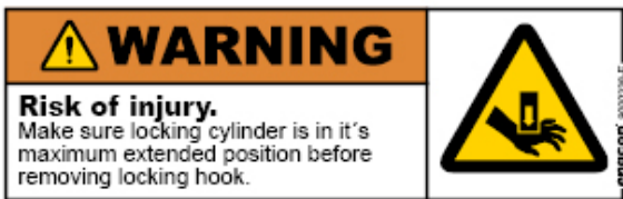
Afbeelding23. Waarschuingssticker op vergrendelcilinder.
